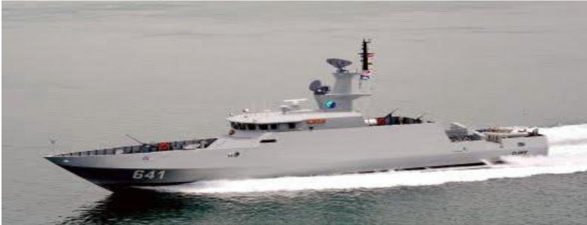
Kapal ini terbuat dari bahan baja bertekanan tinggi dan aluminium *alloy*. Dengan pengalaman lebih dari 20 tahun, P.T. Palindo Marine telah berhasil memproduksi 200 kapal yang menggunakan bahan GRP (*Sandwich*) dan aluminium *alloy* dengan berbagai tipe dan ukuran.
