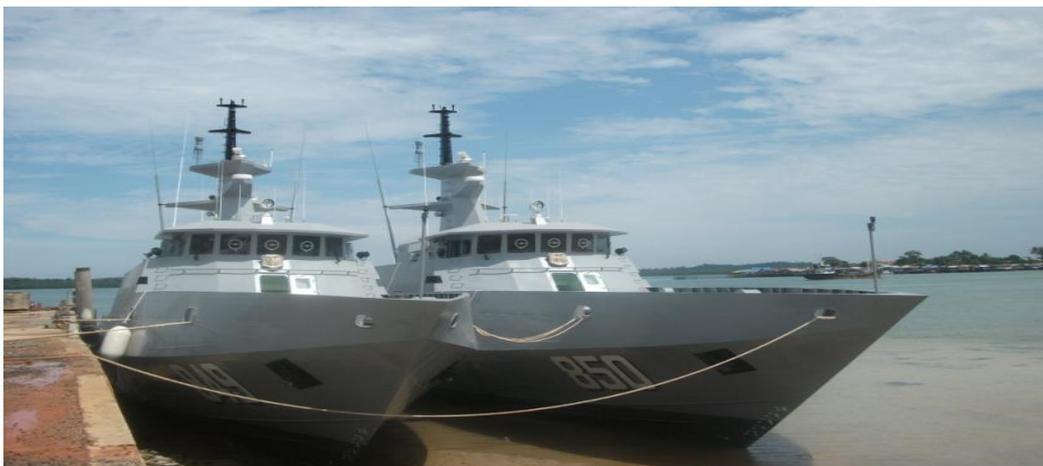
Kapal patroli cepat ini terbuat dari bahan baja bertekanan tinggi dan aluminium *alloy*. Dengan pengalaman lebih dari 20 tahun, P.T. Palindo Marine telah berhasil memproduksi 200 kapal yang menggunakan bahan GRP (*Sandwich*) dan aluminium *alloy* dengan berbagai tipe dan ukuran
