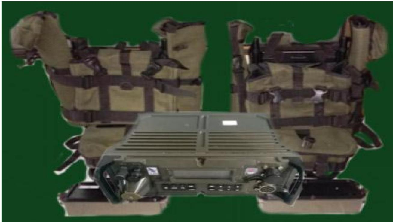
LenGTA-10 adalah radio *manpack* yang didesain untuk komunikasi darat-ke-udara. LenGTA-10 sangat cocok digunakan dalam misi taktis yang memerlukan komunikasi darat-ke-udara jarak pendek dan menengah
