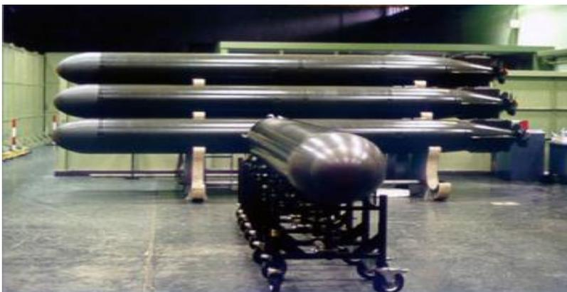
SUT Torpedo dirancang untuk menghadapi target kapal selam dan kapal permukaan. Torpedo SUT tidak hanya dapat diluncurkan dari kapal selam dengan metode *swim-out*, melainkan juga dari kapal permukaan dengan metode *pneumatic push-out*.
