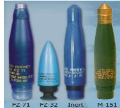
Roket RD 702 MOD.4 setara dengan roket khusus MK-66 Motor Roket MOD.4, yang juga sejenis dengan Roket 2,75". Roket ini dirancang khusus untuk ditembakkan dari helikopter atau pesawat tempur dengan kecepatan rendah. Keakuratan dan total impuls yang cukup tinggi dari MK-40 cukup mengurangi waktu penerbangan dan dispersi. Hal ini memungkinkan jangkauan radius hingga 4.000 meter, dan sampai 10.426 meter untuk tembakan dari darat ke darat (G to G)
