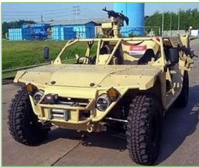
P6 ATAV adalah rantis serang ringan (*light strike vehicle*) yang dibuat oleh SSE Defence. P6 ATAV memiliki rangka tubular dan body terbuka, dengan material penyusunnya berupa baja kelas tinggi dan dual alumunium.
